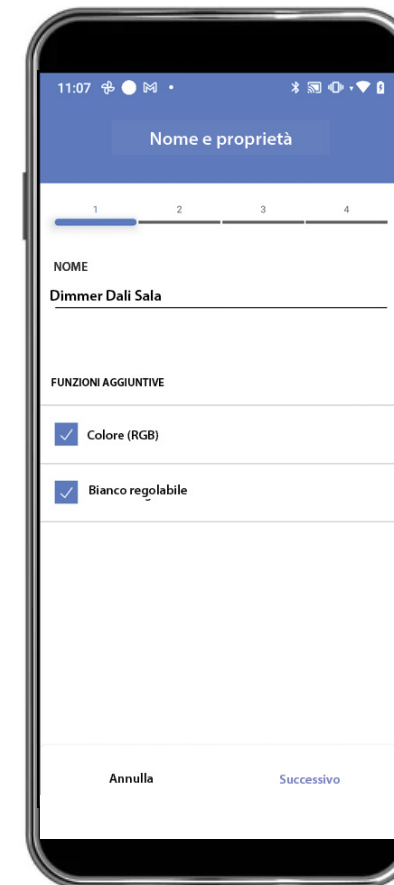
Dimmer DALI2: configurazione delle funzioni.
