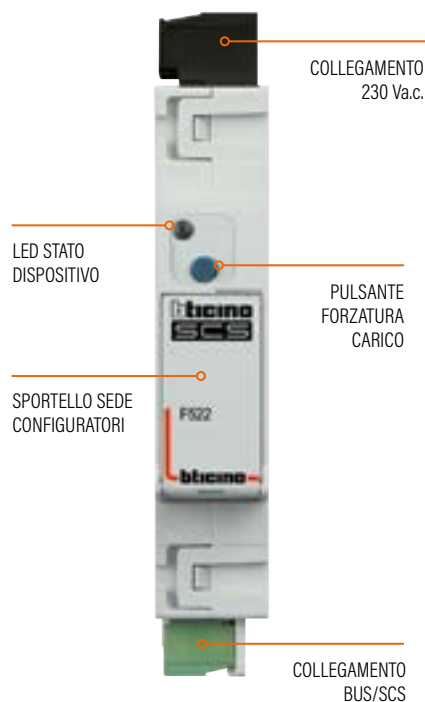
Attuatore 16A con sensore di corrente art. F522.
