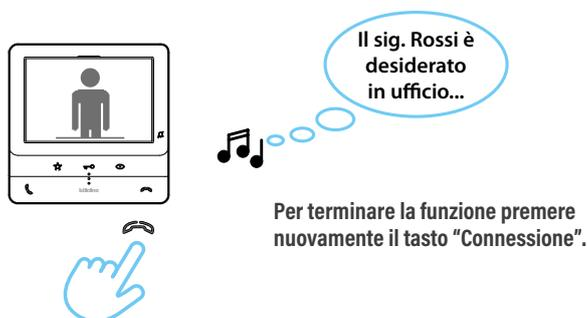
L'attivazione avviene premendo brevemente il tasto "Connessione" con dispositivo in stato di riposo, il LED verde acceso indica che la funzione è attiva. L'attivazione della fonica avviene automaticamente.
