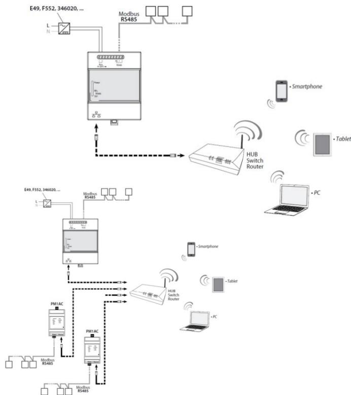
**Configurazione 2:** il Mini Web server è utilizzato come gateway Modbus/IP (alcuni dispositivi Modbus RS485 sono collegati direttamente alla porta RS485 del Web server) e come "Concentratore" di Gateway IP
