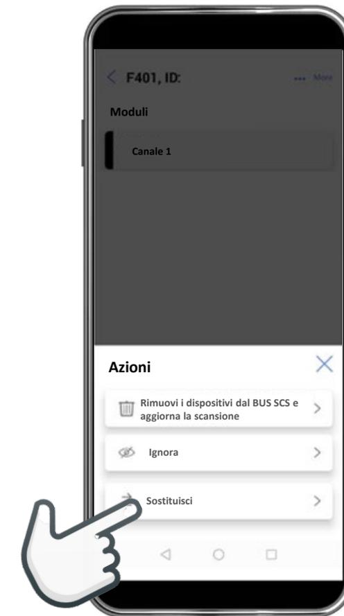
Scegliendo «Sostituisci» si avvia la procedura per il trasferimento della configurazione al nuovo dispositivo
