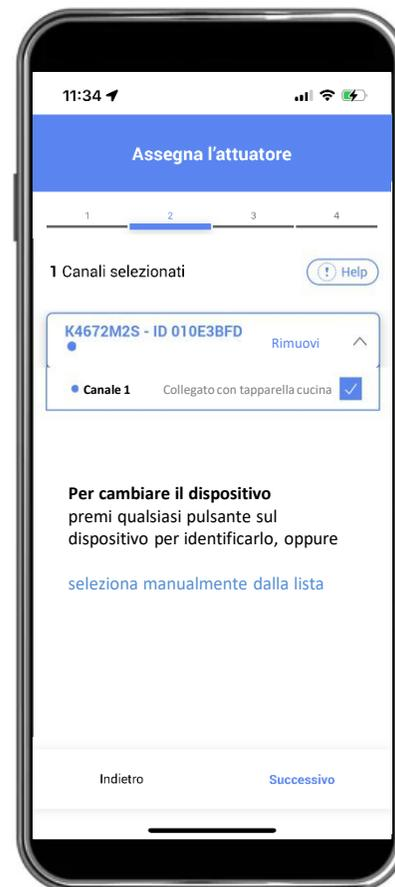
Selezione dell'attuatore; nell'esempio il modello art. K4672M2S per tapparelle
