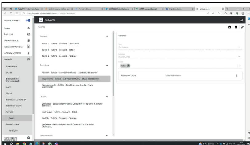
Nel menù **Eventi**, crearne uno. In **Tipo** selezionare una **Partizione** In **Sottotipo** scegliere ad esempio **Inserimento** In fine in **Entità** mettere per esempio **Tutte** Attivazione Uscita - Stato inserimento
