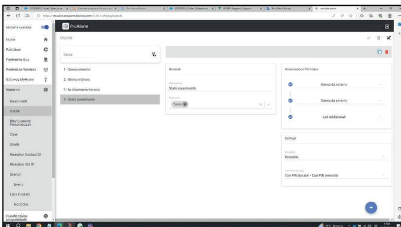
Dal software ProAlarm, nel menù **Uscite**, con il pulsante blu creare una nuova uscita, ad esempio **Stato inserimento**
