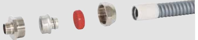
La continuità elettrica è assicurata dalla virola filettata in acciaio che si avvita all'interno dell'anima metallica. Quest'ultima, in caso di necessità, protegge anche dalla trecciatura del guidacavo.
