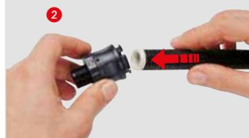
Quindi si inserisce completamente il guidacavo all'interno del raccordo e si ruota la ghiera in posizione di sicurezza On.
