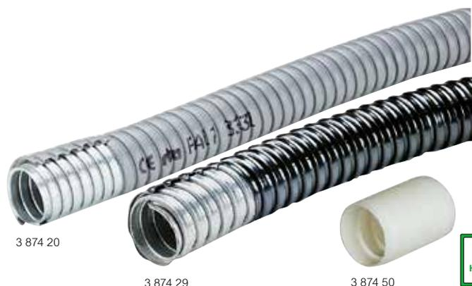
Guidacavo metallico pieghevole a semplice aggraffatura con rivestimento plastico in PVC aspirato. Garantisce buona flessibilità e buone caratteristiche di resistenza meccanica; abbinato ai raccordi serie 2000 Metal e ai manicotti garantisce una protezione IP67.
