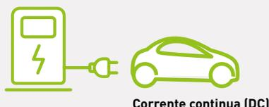
**Prevede il collegamento con il veicolo EV tramite specifici connettori, un cavo fisso e la comunicazione in digitale con il veicolo stesso.** Caricabatterie all'interno della stazione – fino a 500 A / 1000 V. Connettori Standard tipo: CCS (standard Europeo) e CHAdeMO (standard Giapponese).
