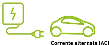
**Prevede la presenza di un dispositivo di protezione integrato nella stazione di ricarica.** Collegamento del veicolo EV alla rete con prese dedicate – fino a 22 kW (32 A). Comunicazione tra stazione e veicolo tramite protocollo PWM (Pulse Width Modulation).
