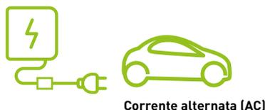
**Prevede la presenza di un dispositivo di protezione generalmente integrato nel cavo in dotazione con il veicolo.** Collegamento del veicolo EV alle normali prese domestiche 230 Vac fino a 16 A max o prese industriali fino a 32 A max.
