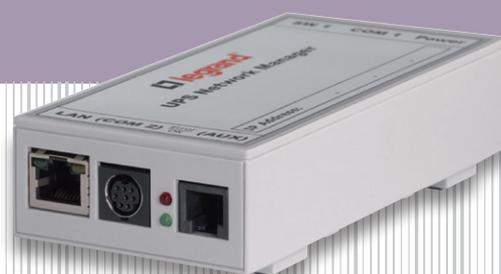
Le interfacce di rete sono dispositivi hardware per la gestione degli UPS, non richiedono software, al loro interno infatti risiede un sistema operativo proprietario in grado di controllare continuamente il funzionamento dell'UPS e gestire molteplici eventi (mancanza rete, sovraccarico, bypass, anomalia, ...).
