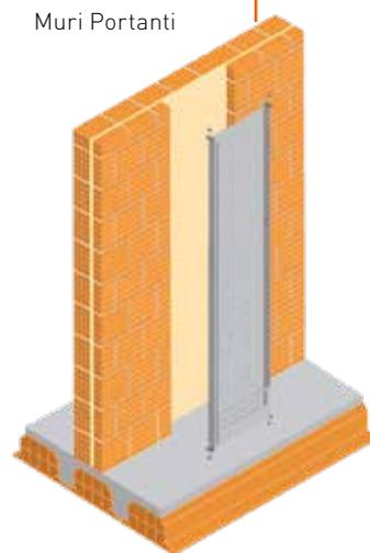
**NOTA:** per l'installazione in muri portanti ricavare un vano della larghezza di circa 60 cm da pavimento a soffitto, per pareti divisorie o in cartongesso lasciare un'apertura di circa 60 cm durante la costruzione della parete.
