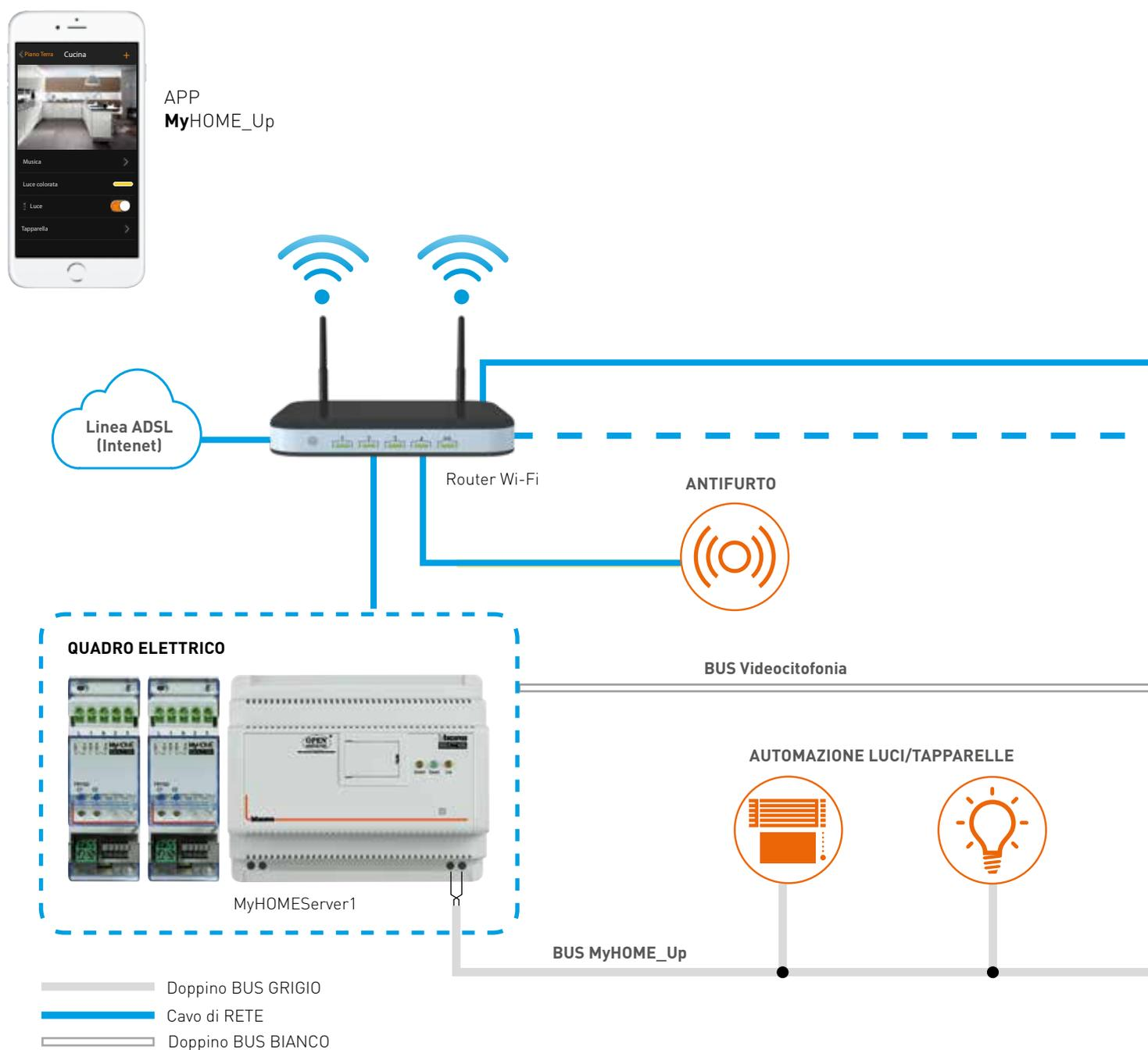
Il dispositivo **MyHOME Server1** è il cuore di tutto il sistema integrato. In fase di messa in funzione dell'impianto viene utilizzato per riconoscere ed associare tra loro tutti i dispositivi presenti e svolge la funzione di gateway per consentire all'utente di controllare le funzioni dell'impianto e di prodotti di terze parti mediante touch screen HOMETOUCH, comandi vocali Amazon Alexa e Google Home, oppure in remoto con Smartphone e App **MyHOME\_Up**.
