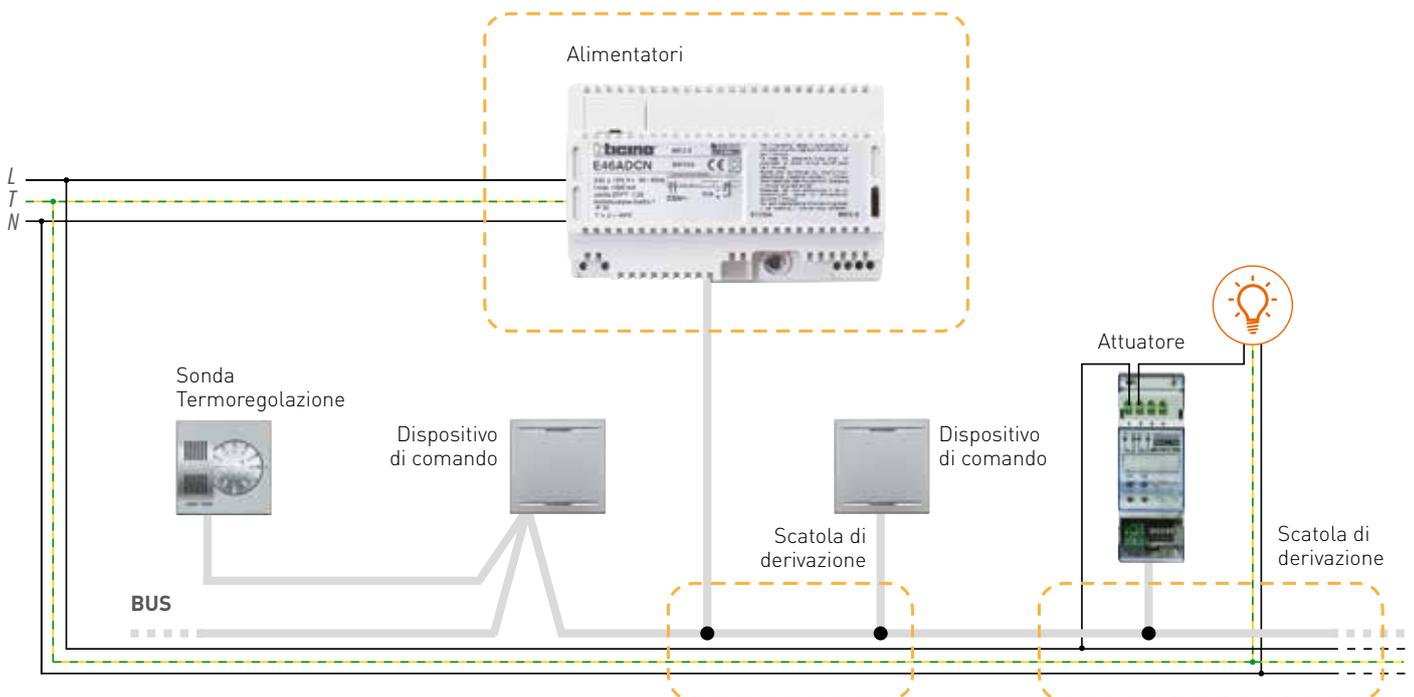
**Installazione distribuita:** gli attuatori, come i dispositivi di comando, sono installati in scatole portapparecchi o di derivazione.
