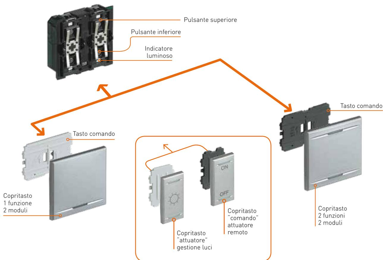
**Attuatore art. LN4672M2 Livinglight** con 1 relè 10 A per lampade ad incandescenza 4 A per lampade fluorescenti o trasformatori ferromagnetici e 500 W per lampade a LED e fluorescenti compatte destinato alle funzioni di Automazione e/o Gestione controllo carichi.
