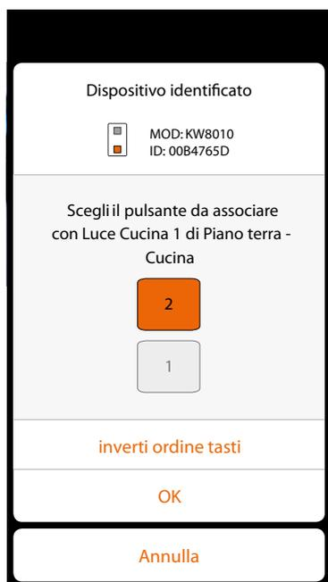
Messa in funzione dell'impianto MyHOME\_Up - definizione del comando LUCE per il comando di due luci.
