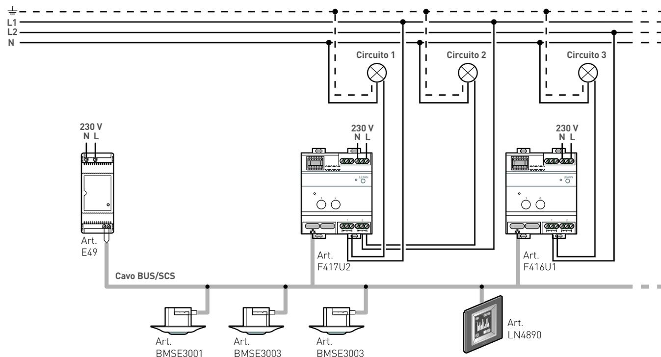
1. Installare i sensori SCS da soffitto a doppia tecnologia o infrarossi passivi art. BMSE3003 e BMSE3001 al centro di ognuna delle aree da controllare.
