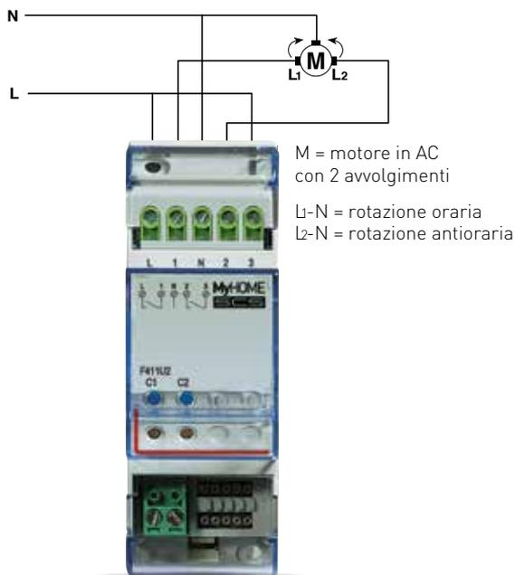
Attuatore art. **F411U2** a 2 relè per il controllo ON/OFF dell'illuminazione. Nello schema il dispositivo è cablo per il controllo di una tapparella motorizzata e deve essere impostato nella modalità "interblocco dei relè".
