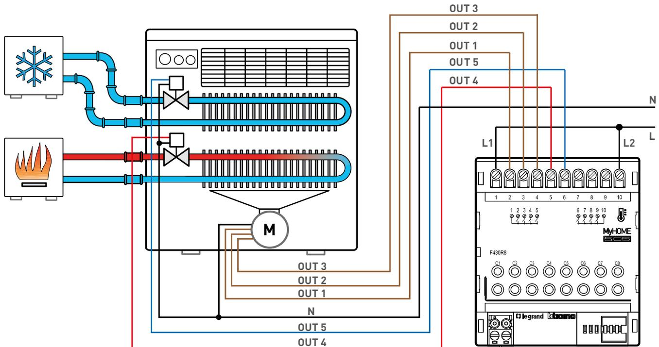
Impiego dell'attuatore F430/8 per il controllo di un Fan coil a 4 tubi e 3 velocità.
