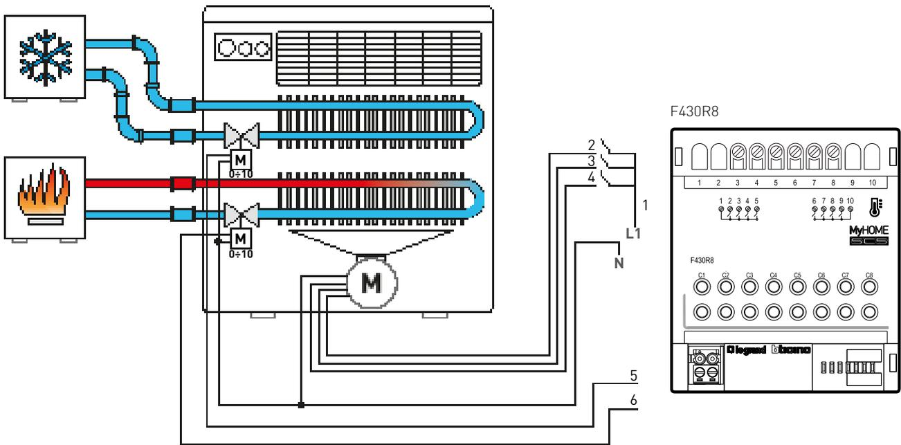
Variante per collegamento di un fan-coil 4 tubi con regolazione della velocità 0 - 10 V
