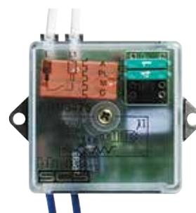
**Attuatore art. 3476** con 1 relè per carichi singoli: 2 A resistivi o lampade ad incandescenza, 2 A induttivi per trasformatori ferromagnetici. Predisposto per collegamento con pulsante di comando tipo NO.
