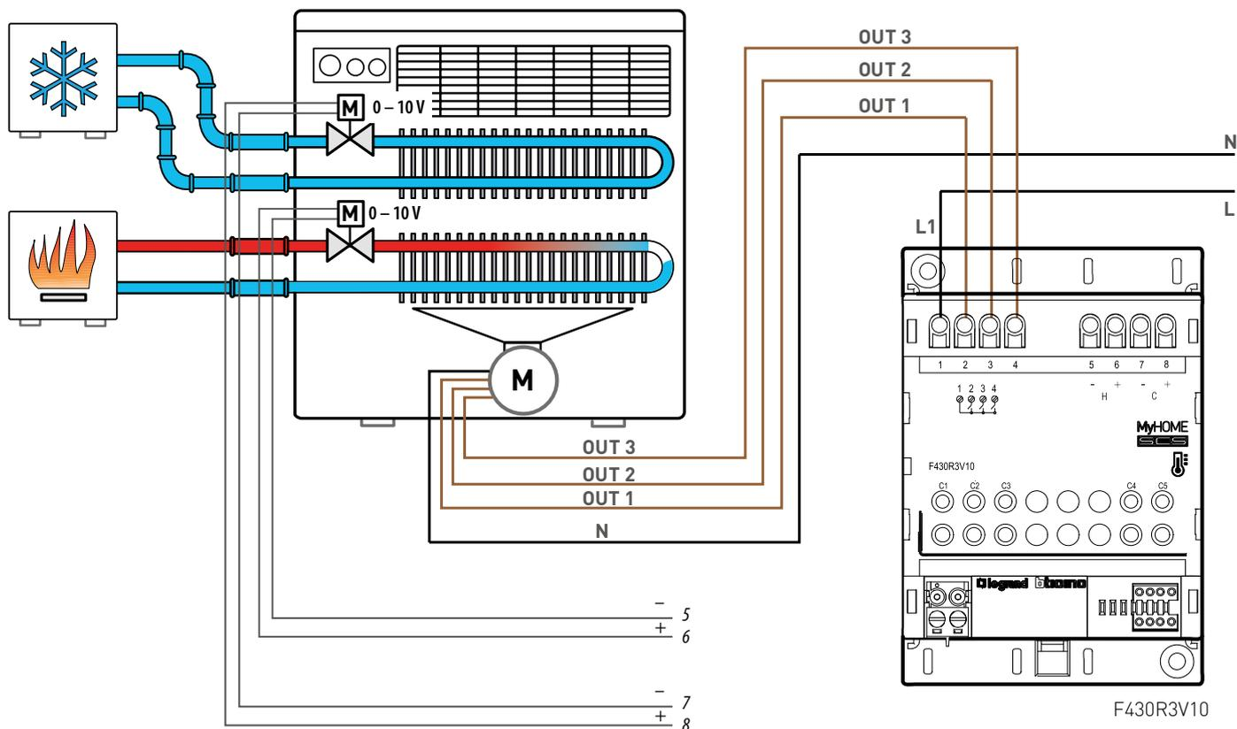
Impiego dell'attuatore F430R3V10 per il controllo di un Fan coil a 4 tubi con valvole 0-10 e 3 velocità.
