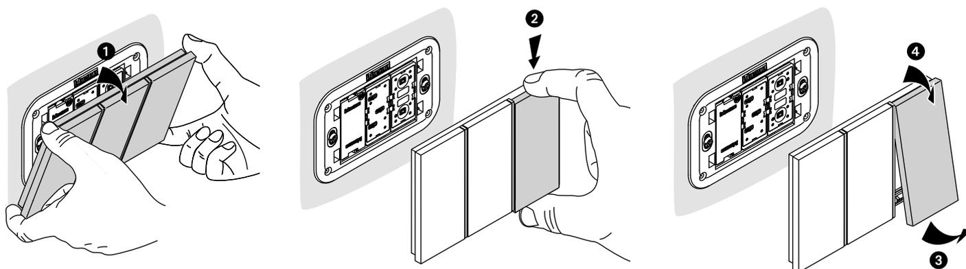
Rimozione dei dispositivi di comando dal frame elettrificato per eventuale installazione in un'altra posizione.
