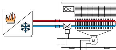
**Installazione dell'elettrovalvola in fan-coil a 4 tubi**
