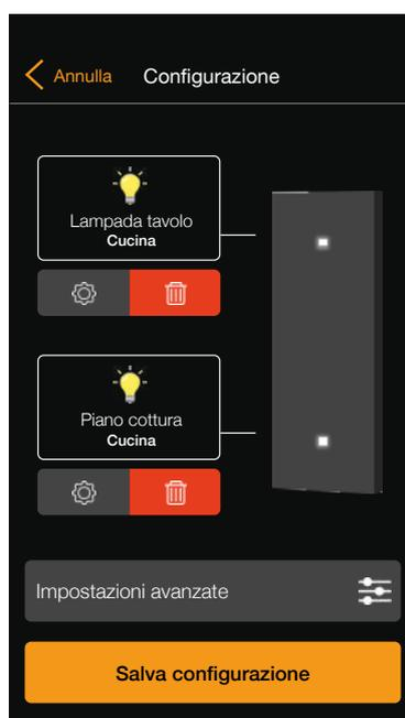
Personalizzazione delle funzioni da parte dell'utente - definizione del comando FULL per il comando di 2 distinti punti luce.
