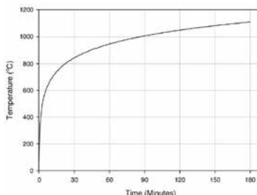
L'omologazione concessa (E90, E60, E30) si ottiene per una gamma e un carico predefiniti. Il criterio per la convalida dei sistemi di resistenza al fuoco è definito dal superamento del test e cioè dal mantenimento dell'integrità funzionale per tutto il tempo della prova.
