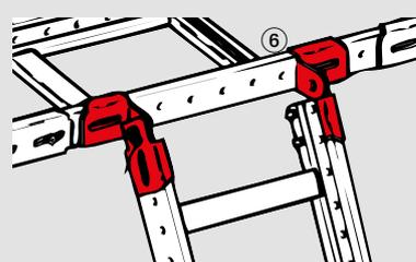
**Esempio di montaggio giunto a snodo orizzontale**
