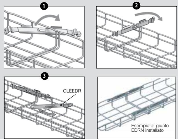
Utensile di montaggio CLEEDR in dotazione in ogni confezione di giunti EDRN
