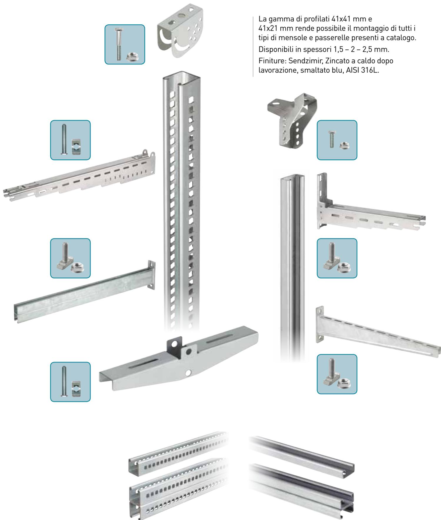
La gamma di profilati 41x41 mm e 41x21 mm rende possibile il montaggio di tutti i tipi di mensole e passerelle presenti a catalogo. Disponibili in spessori 1,5 - 2 - 2,5 mm. Finiture: Sendzimir, Zincato a caldo dopo lavorazione, smaltato blu, AISI 316L.
