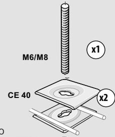
Utilizzata per la sospensione a soffitto centrale (barra filettata M6/M8) o per la costruzione dei cambi di direzione
