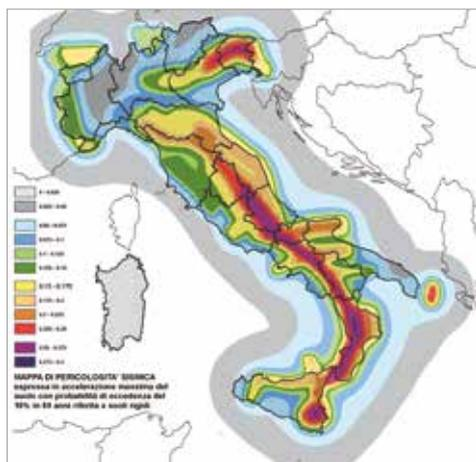
La pericolosità sismica viene valutata in base alla componente orizzontale dell'accelerazione sismica massima attesa del suolo  $a_g$  che deve essere correlata, attraverso opportuni coefficienti che tengono conto della natura del terreno, al luogo fisico in cui sorgerà la costruzione.
