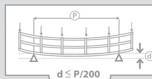
**Nota:** la freccia massima 1/20 è sempre riferita ad un carico, inferiore al carico pratico di sicurezza (carico di rottura diviso coefficiente di sicurezza standard di 1,7).
