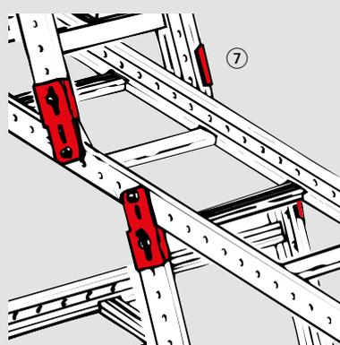
**Esempio di montaggio giunto laterale**
