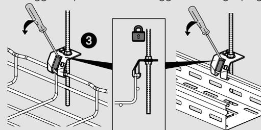
Ulteriore fissaggio con kit
