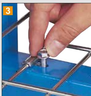
Fissaggio della vite nel foro filettato e bloccaggio del giunto. È consigliabile l'utilizzo di 1 giunto mensola per la larghezza ≤300 e 2 giunti mensola per la larghezza >300 mm.
