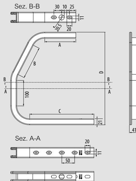
La mensola tunnel può essere montata a parete e sui soffitti inclinati
