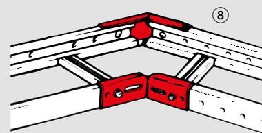
**Esempio di montaggio giunto a snodo verticale**
