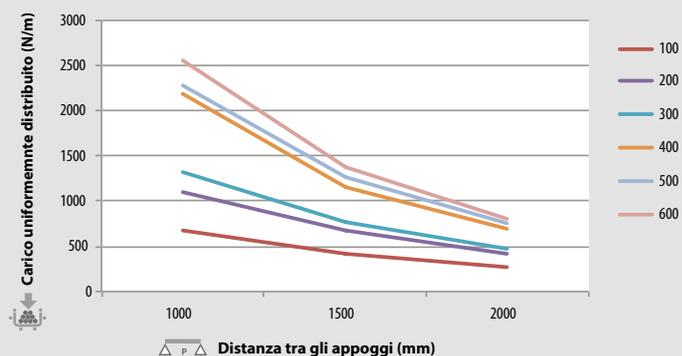
Per le altezze H25 e H50 posizionando il giunto a L/5 il carico può essere aumentato di un fattore 2
