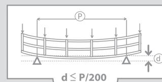
**Nota:** la freccia massima 1/20 è sempre riferita ad un carico, inferiore al carico pratico di sicurezza (carico di rottura diviso coefficiente di sicurezza standard di 1,7).
